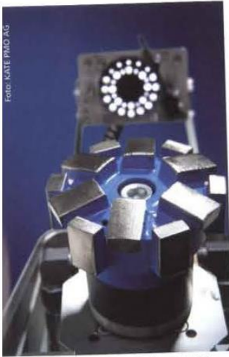
Bild 1: Fräsröbter werden für präzise Fräs-, Bohr- und Schleifarbeiten in Rohrleitungen bis DN 800 eingesetzt
