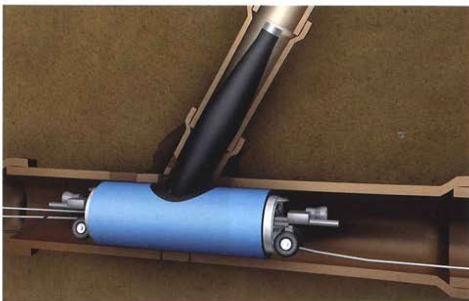
Bei der Zulaufsanierung können ursächlichen Gründe für gebrochene Anschlüsselemente mit behandelt und das Rohr-Bodensystem lokal stabilisiert werden. | Foto: Umwelttechnik Franz Janßen GmbH
